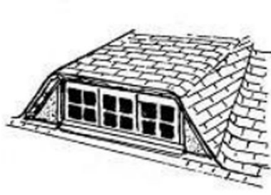
lucarne en trapèze ou rampante à jouées biaises (couverture en bardeaux d'asphalte)
