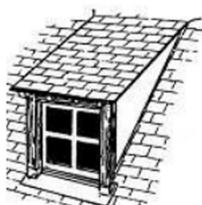
lucarne rampante ou en chien couché
