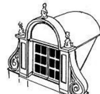
lucarne- fronton ici à ailérons et toit bombé
